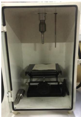
Fig. 3. Probe Ultrasonicator
