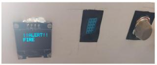
Fig. 4. Gas alert on display
